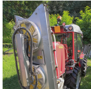
Hydraulisches Drehgebläse Convogliatore girevole idraulico Hydraulic revolving blower
