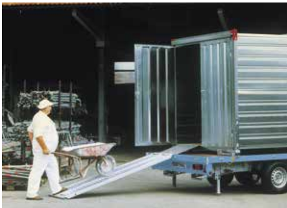
SP mit Zubehör: Alu-Auffahrrampen und Alu-Auffahrblech zum Befahren des Containers auf dem Anhänger.
