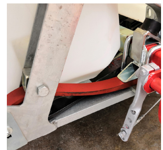
Blattfedernde Aufhängung Sospensione a balestra Leaf spring suspension
