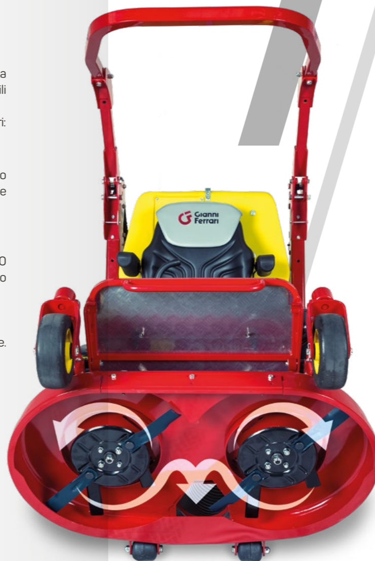
Rotazione contraria delle lame
